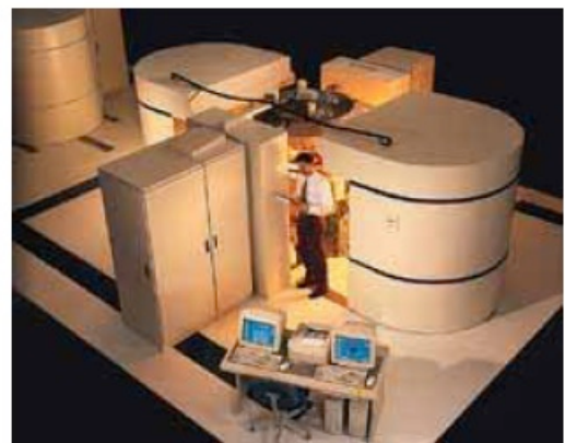
写真4：CTI社製のRDS111 (CTI社HPより抜粋) 11MeVの - H専用機。
