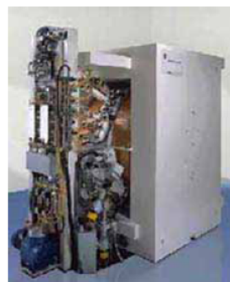
写真7：GE社製『PETTrace』。垂直型のレイアウト。2時間照射で最大8 Ci の ^{18}\text{F} ターゲット収量を引き出す。エネルギーは16 MeV (GE社のHPより)
