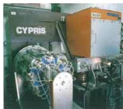
写真2：住友重機械製 CYPRIS325 型の初号機。加速エネルギーは陽子 15MeV、重陽子 7.8MeV。ターゲット1ポートに8連のリボルバータイプのターゲット装着された。京都大学付属病院納入（1982年）。
