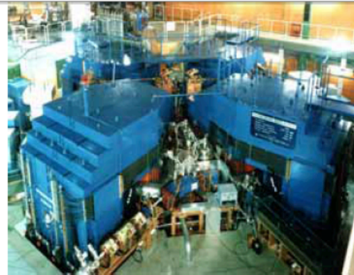
写真1：理化学研究所の分離セクター型サイクロトロン。 （K=540MeV）総重量は2400トンにもなる。
