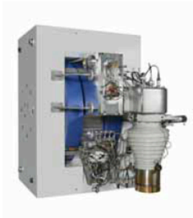
写真6：住友重機械『HM-12S』。自己シールドで垂直型のレイアウト。2時間照射で最大7 Ci の ^{18}\text{F} ターゲット収量を引き出す。エネルギーは12 MeV
