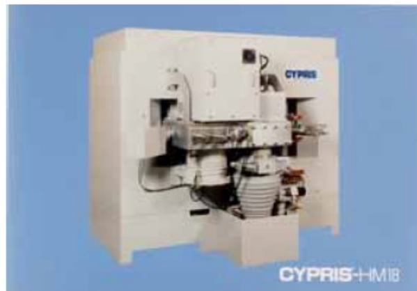
写真3：住友重機械製の負イオン加速サイクロトロン。加速エネルギーは陽子 18MeV、重陽子 10MeV。ターゲットは8個装着可能。(1992年)
